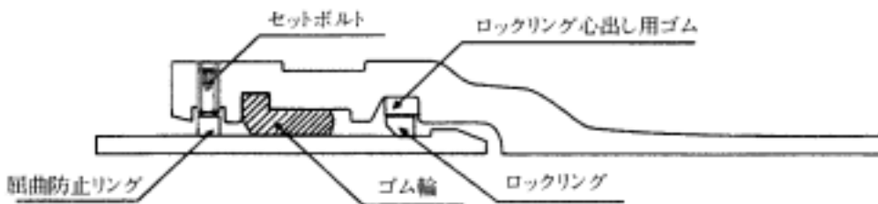
図 - 4 - (1) - 4 NS形異形管継手 ( 75 ~ 250 )
