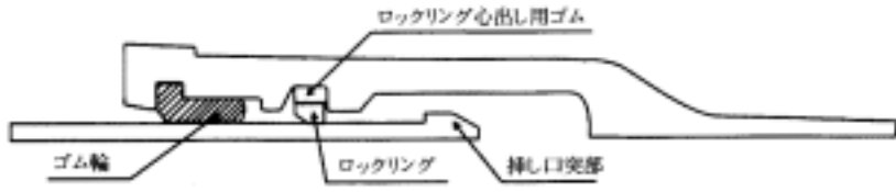
図 - 4 - (1) - 2 NS形直管の継手構造 ( 75 ~ 450 )
